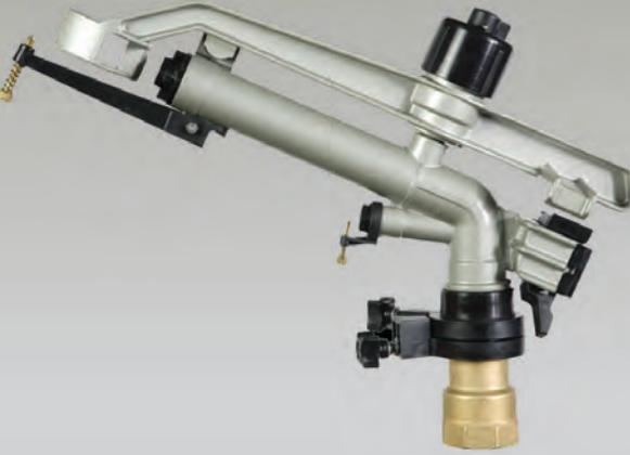
**Дождеватель средней производительности** в двух вариантах: секторный (круговой и секторной полив) и круговой (только круговой полив). Оснащен различными сменными насадками и регулируемым прерывателем, обеспечивающим равномерное распределение осадков по всей площади орошения. Простота и универсальность являются одними из его основных характеристик, фактически, его можно применять во всех сферах земеделия.
