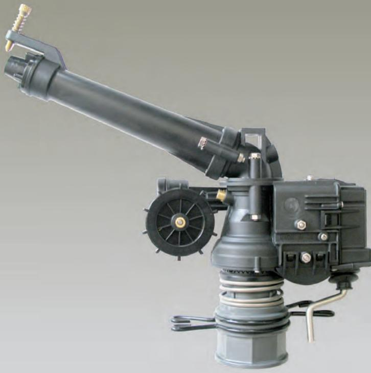
**Спринклер с малым и средним напором** для систем среднего давления, врачающийся с постоянной скоростью по полному или частичному кругу. Он оснащен сменными форсунками разного размера и регулируемым прерывателем, обеспечивающим равномерное распределение дождя по всей орошающей площади. Исключительная равномерность и легкость полива делают его особенно подходящим для полива нежных растений, таких как рассада, цветы и овощи.
