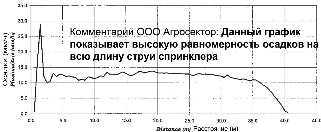
Распределение осадков внутри различных диспозиций
