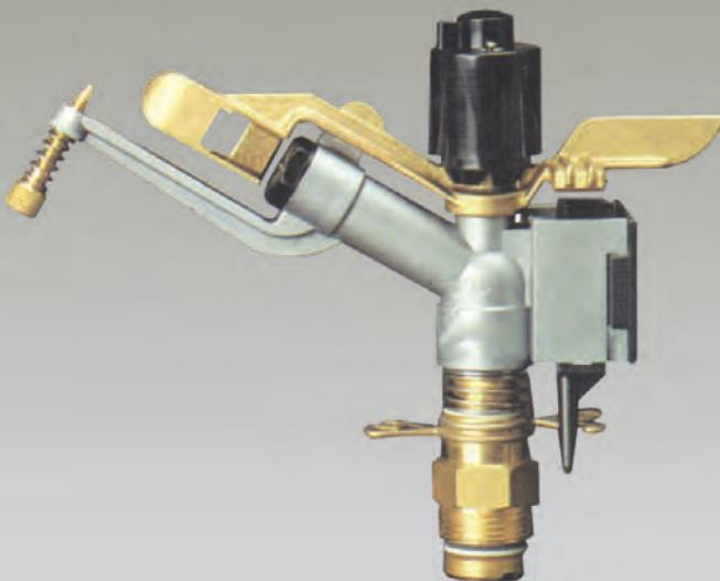
**Специальный спринклер**, особенно подходящий для полива виноградников, садов и огородов при низком давлении и небольшом количестве осадков в час. Изготовлен из латуни и рильсана, доступен в частичном круге. Оснащен сменными насадками и регулируемым прерывателем. Подходит для полива и защиты от мороза.
