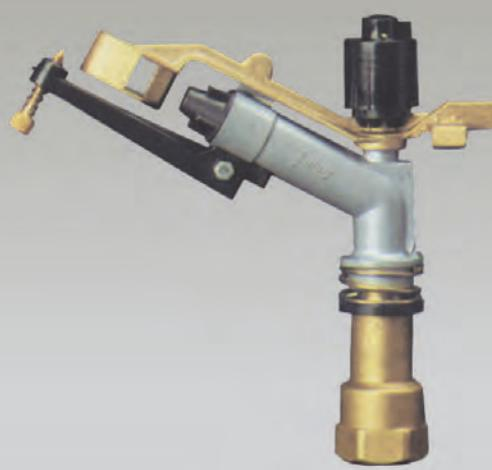
**Спринклер малой производительности**, доступен в двух вариантах: секторная и круговая модели. Он оснащен различными сменными форсунками и регулируемым прерывателем, который обеспечивает более точное распределение осадков. Подходит для полива смешанных культур, садов, огородов, полей для гольфа и защиты растений от заморозков.
