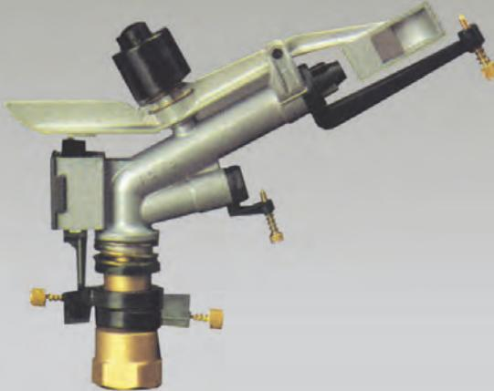
**Спринклер малой и средней производительности**, доступен в двух вариантах исполнения: секторная и круговая модели. Две форсунки разного наклона оснащены сменными форсунками разного размера и регулируемыми прерывателями, что позволяет получать мелкие и хорошо распределенные осадки по всей орошаемой поверхности. Он особенно подходит для глубокого орошения интенсивных культур, таких как овощи и декоративные растения.
