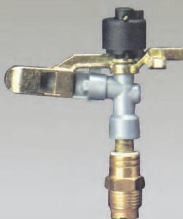
**Спринклер малой производительности** из латуни, алюминия и рилсана. Он доступен в полном или частичном круге. Он оборудован регулируемым выключателем струи. Благодаря низкому углу наклона рекомендуется для полива садов и виноградников под деревьями, для полива тепличных растений и всех видов культивации на ветреных землях.
