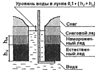
Рис. 3.1. Измерение толщины ледяного покрова градуированной рейкой.
